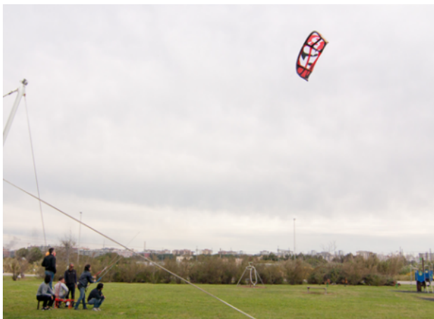
Fig. 14 - Prova di volo di acquilone strumentato
